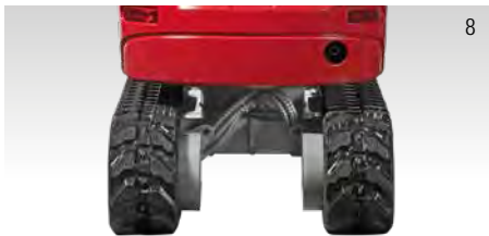
LARGEUR DU TRAIN DE ROULEMENT RÉTRACTÉ 750 MM
