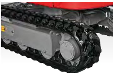
OUILLETS D'ARRIMAGE DU TRAIN DE ROULEMENT
