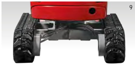
LARGEUR DU TRAIN DE ROULEMENT DÉPLOYÉ 1 020 MM
