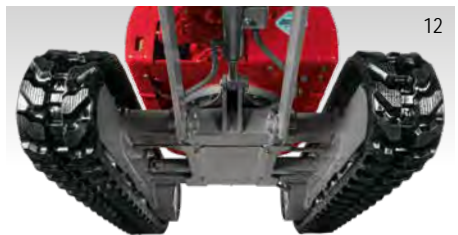
TRAIN DE ROULEMENT HYDRAULIQUE RÉGLABLE
