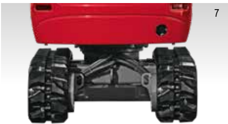
LARGEUR DU TRAIN DE ROULEMENT RÉTRACTÉ 980 MM
