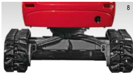
LARGEUR DU TRAIN DE ROULEMENT DÉPLOYÉ 1 300 MM
