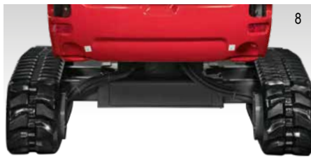
LARGEUR DU TRAIN DE ROULEMENT DÉPLOYÉ 1500 MM
