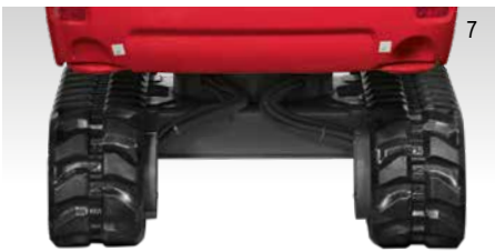
LARGEUR DU TRAIN DE ROULEMENT RÉTRACTÉ 1100 MM
